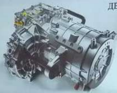
рис. 2.15-7 Электропривод «три в одном» в сборе ES8
